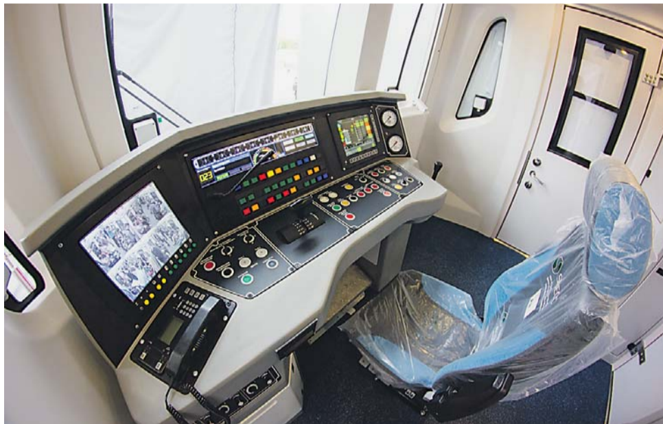
Пульт машиниста вагона метро модели 81-765.
