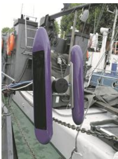
Антенны гидролокатора бокового обзора «Неман». Фото Ивана Боровикова
